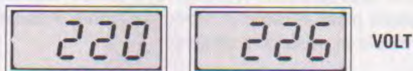
Fig.11 Per le misure in tensione la risoluzione è di +/- 1 volt. Se sul display appare 226 volt, il valore effettivo della tensione può risultare di 225 o 227 volt.
