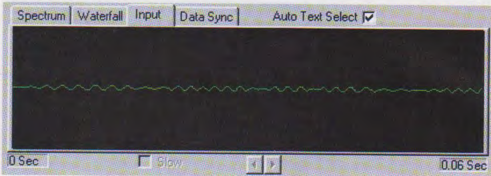
Fig.15 Dopo aver collegato la nostra interfaccia tra il ricevitore e il computer e aver selezionato nella finestra di fig.13 la riga "RX level Adjust", dovete muovere la manopola Line-In (vedi fig.14) in modo da dosare il segnale sull'ingresso della scheda Audio. Se nel grafico Input appare una linea quasi impercettibile, il segnale di BF è insufficiente.
