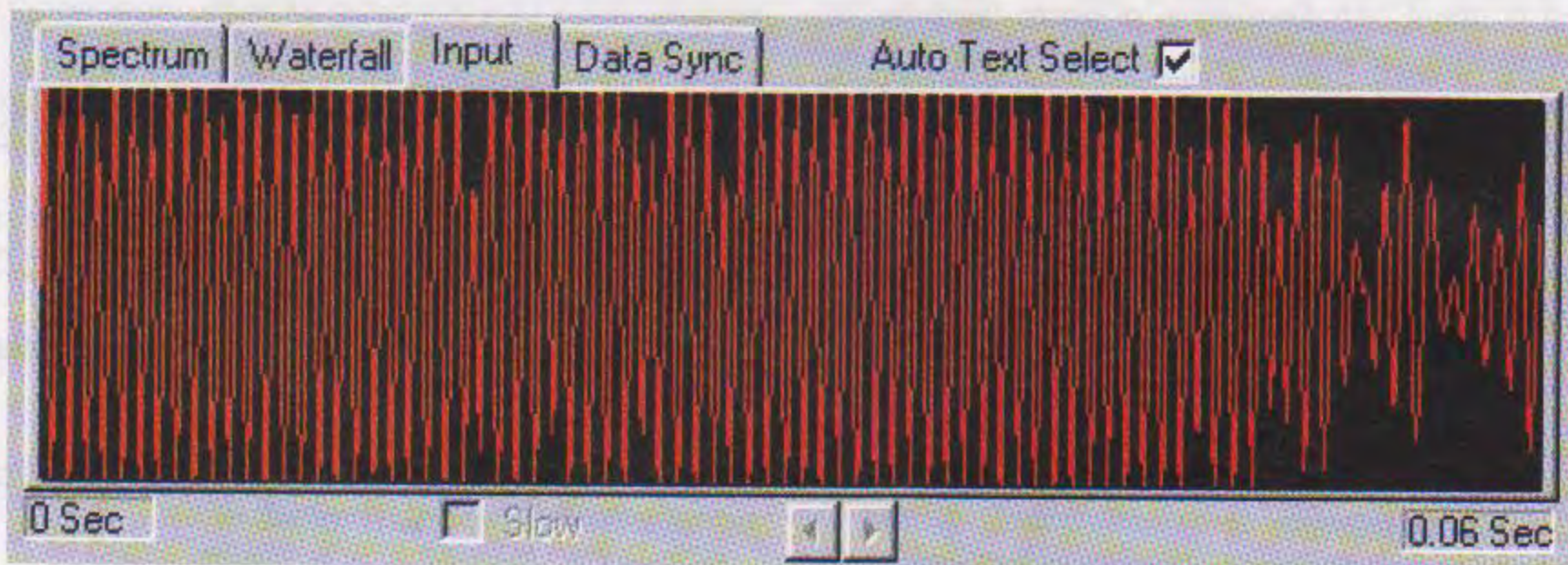
Fig.16 Se notate che l'ampiezza delle sinusoidi riesce a coprire tutto lo schermo, potete essere certi che l'ampiezza del segnale di BF applicato sull'ingresso è esagerata, quindi dovete abbassarla spostando verso il basso la manopola "Line-In" oppure potete agire direttamente sul potenziometro del Volume del ricevitore.
