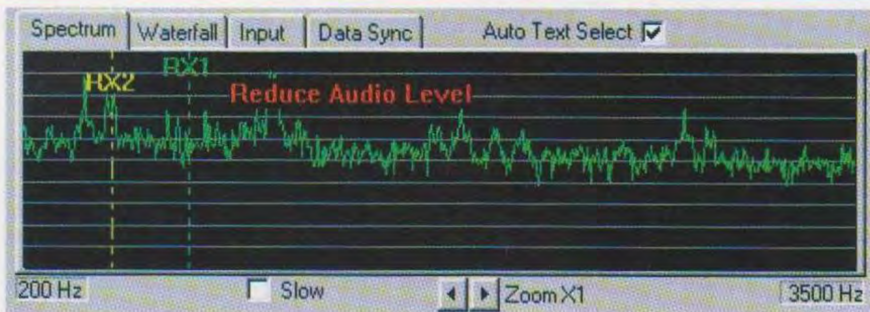
Fig.18 Se l'ampiezza del segnale è esagerata, vedrete apparire sullo schermo la scritta in rosso "Reduce Audio Level". Se non volete agire sulla scheda Sound-Blaster potete ruotare verso il minimo il potenziometro Volume del ricevitore.
