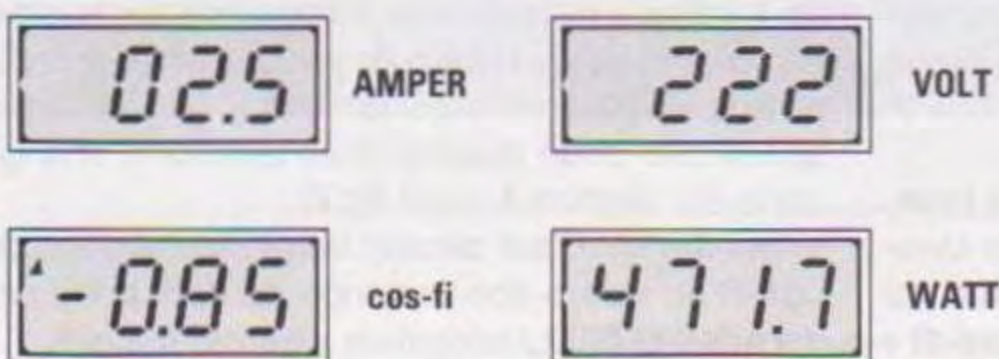
Fig.4 Per misurare lo sfasamento tra tensione e corrente si utilizzano due rivelatori di Zero Crossing, poi si convertono le onde sinusoidali in onde quadre perché è più facile controllare quando passano da livello logico 0 a livello logico 1 e viceversa. Il segnale della Tensione viene prelevato dal secondario del trasformatore T1 e applicato ai piedini 7-4 del microprocessore IC4, mentre il segnale della Corrente viene prelevato dal nucleo toroidale L1 e applicato ai piedini 8-10 dello stesso microprocessore.
