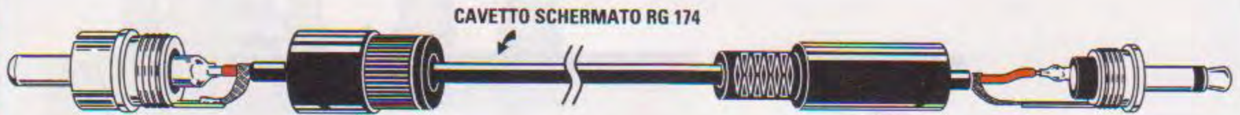
Fig.6 Per collegare l'interfaccia al Ricetrasmittitore e al Computer dovete utilizzare dei corti spezzoni di cavetto coassiale tipo RG.174. Ad una estremità di questo cavetto va collegato lo spinotto maschio tipo RCA e sull'estremità opposta una presa jack mono. La calza di schermo di questo cavo va saldata sul corpo metallico delle due prese.
