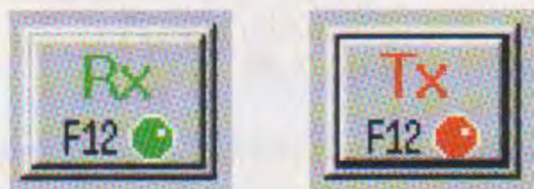
Fig.39 Questo tasto, che appare in basso nella finestra di fig.10, serve per passare dalla ricezione RX alla trasmissione TX. Anziché portare il cursore del mouse su questa finestra e cliccare, potrete pigiare nella tastiera il tasto funzione F12.
