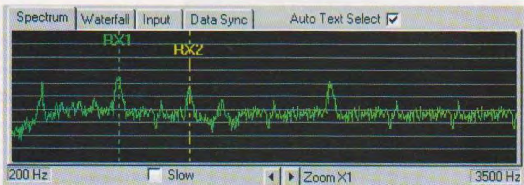
Fig.33 Cliccando sulla scritta "Spectrum" sullo schermo appare questa finestra. Noterete subito le emittenti che trasmettono con il PSK31, perché i picchi dei loro segnali supereranno la normale traccia orizzontale del rumore. Se portate il cursore su uno di questi picchi e cliccate con il tasto Sinistro del mouse il segnale captato verrà definito RX1, mentre se cliccate con il tasto Destro il segnale captato verrà definito RX2.
