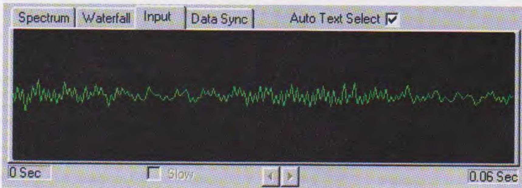
Fig.17 Quando l'ampiezza del segnale di BF risulta correttamente dosata, sullo schermo appare un segnale seghettato, ma molto uniforme, simile a quello qui sopra riportato. Ora potete andare nella finestra dello spectrum (vedi fig.33) e se vedete uno o più picchi a V rovesciata vuol dire che vi sono delle emittenti che trasmettono in PSK31.
