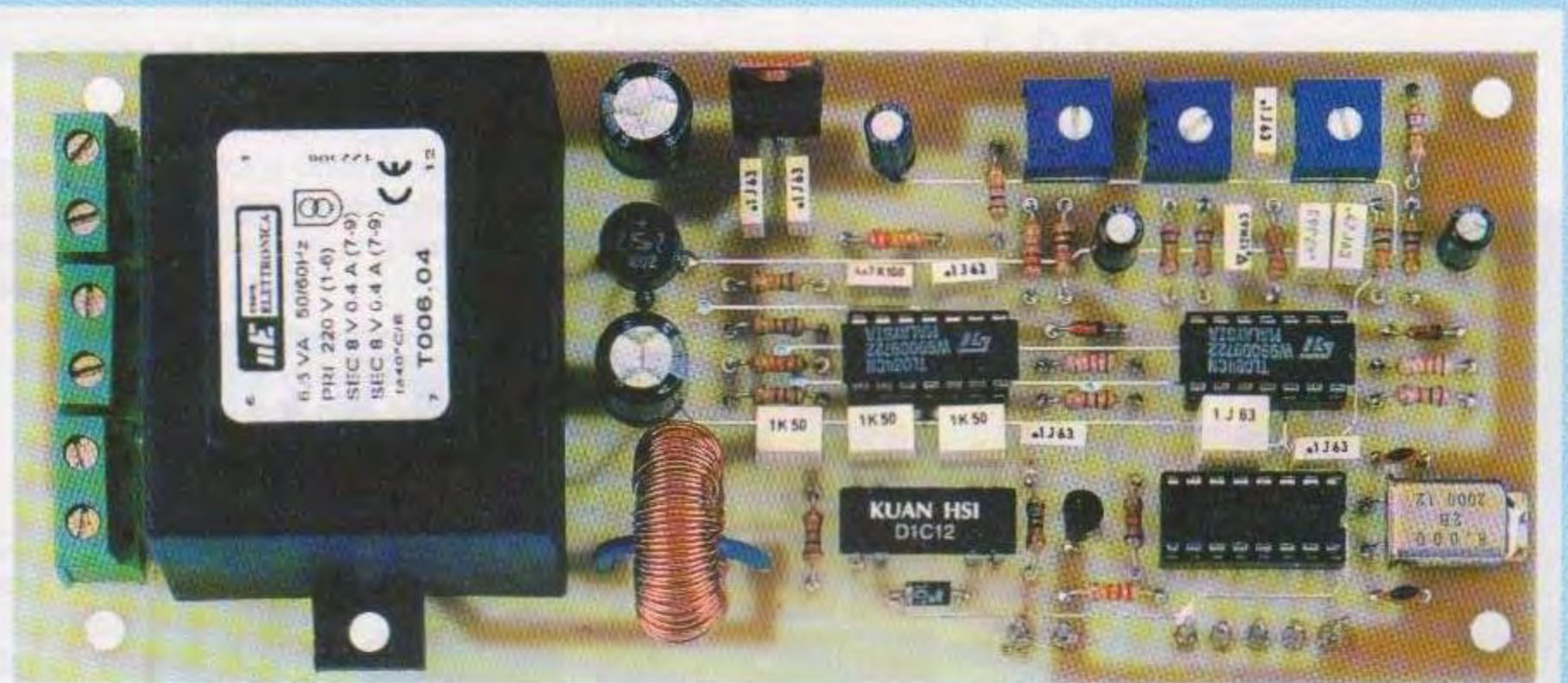
Fig.17 Questa è la foto della scheda base LX.1485 (vedi fig.14) con sopra già montati tutti i suoi componenti. Ai cinque terminali capifilo posti a destra sotto l'integrato IC4 collegherete i fili che partono dallo stampato del display LCD visibile nella fig.18.
