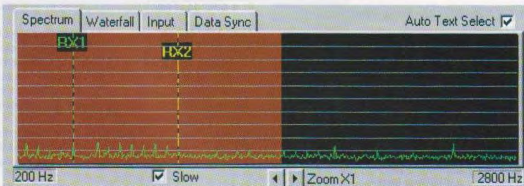
Fig.22 Se nella finestra di fig.19 disabilitate l'opzione "TX matches RX", potete scegliere per la trasmissione un passabanda diverso da quello della ricezione. Se per la ricezione scegliete Start 200 Hz e End 2800 Hz e per la trasmissione scegliete Start 1600 Hz e End 2800 Hz, la finestra dello Spectrum mostrerà un'area con sfondo di colore ROSSO nella quale NON potrete trasmettere. La ricezione avviene sull'intera gamma da 200 a 2800 Hz.
