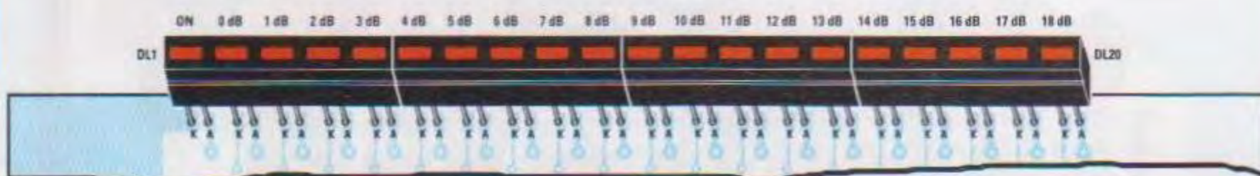
Fig.12 Quando alimentate il circuito, il primo diodo led di sinistra DL1 rimane sempre acceso perché è quello di alimentazione. Il secondo diodo DL2 è quello che indica 0 dB, mentre l'ultimo diodo a destra DL20 è quello che indica il massimo segnale dei 18 dB.
